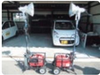
災害発生時に福祉センターがボランティアセンターとして運営できるようにするための発電式投光器
